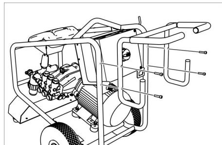
Schubbügel mit den vier mitgelieferten Schrauben befestigen.
