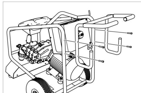
Kiinnitä työntökaari toimitukseen sisältyvällä neljällä ruuvilla.
