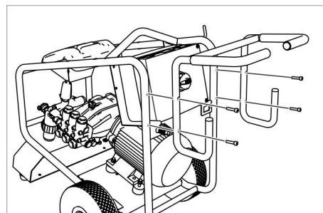
Rögzítse a tolókengyelt a készletben található csavarokkal.
