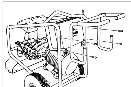
Monter forskydningsbøjlen med de fire vedlagte skruer.
