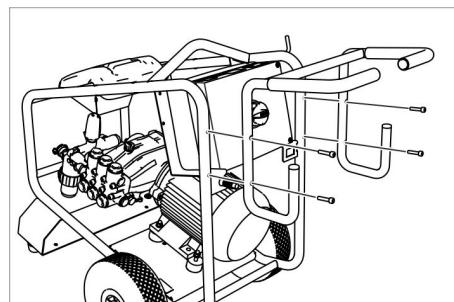
Posuvné rameno připevněte 4 přiloženými šrouby.
