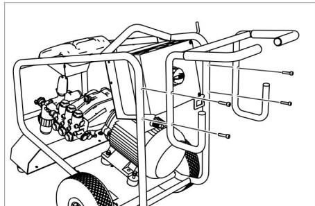
Montera skjutbygeln med de 4 medföljande skruvarna.
